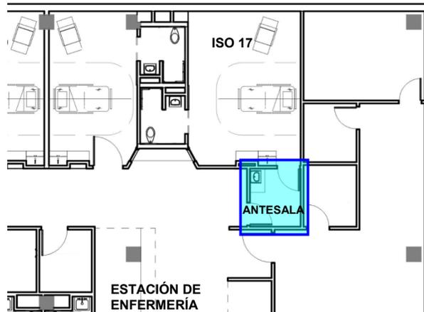
Figura 12. Sala previa para una sala de aislamiento.
